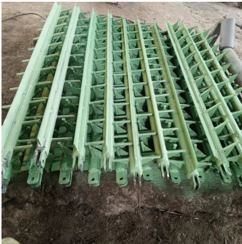
Figura 8. Serie de barajas reforzadas fabricadas y recubiertas. La repetición de geometría muestra la estandarización constructiva alcanzada por el proyecto.
