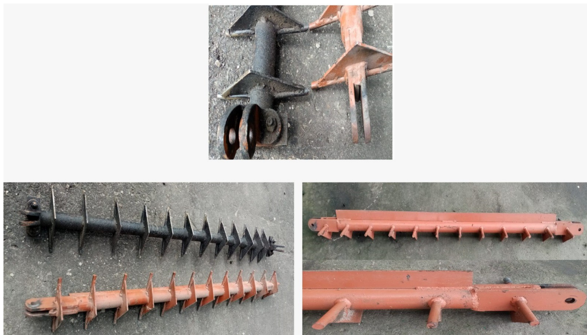
Figura 7. Comparación visual de piezas del sistema y del rediseño. El archivo muestra diferencias en aletas, cargadoras y refuerzos.
