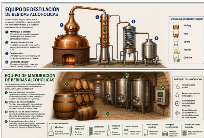
Figura 8. Equipo de destilación empleado en bebidas alcohólicas
