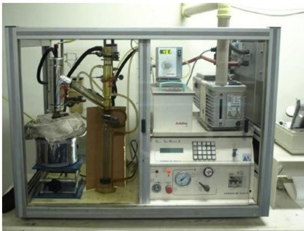
Equipo de destilación al vacío utilizado en el Laboratorio.
