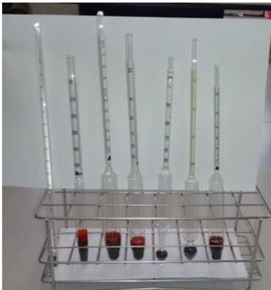
Hidrómetros para densidad utilizados en el Laboratorio.
